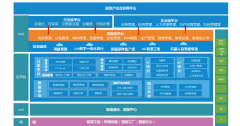
图1 建筑产业互联网平台系统架构
